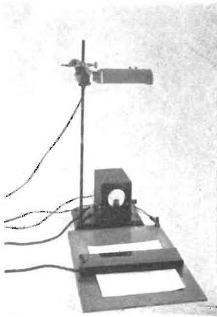
Fig. 1. - L'apparecchiatura necessaria per il processo di stampa col sistema Electrofax.
